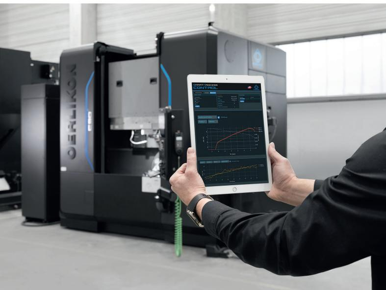
**1** Optimieren und Dokumentieren von Prozessen: Die Software-option Smart Process Control sammelt an Oerlikon Kegelrad-Fräsmaschinen der C-Serie relevante Daten und gibt diese grafisch auf Mobile Devices oder an der Steuerung aus © Klingelnberg
